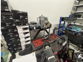
Appareil de vérification d'usure de souliers
