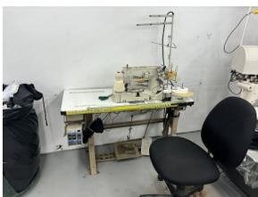
Machine à coudre commerciale, 3 aiguilles, 4 fils
